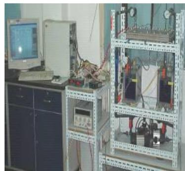
图 3 极板面积 300×500 的液流电池实验电堆
