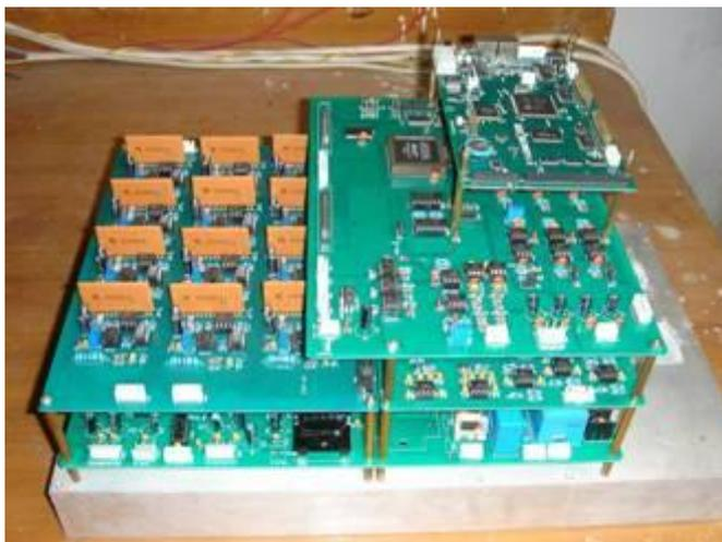
图3 10kW 间接型矩阵式变换器样机
