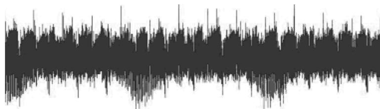
上图中，除尖峰处为人工制造的纱线疵点外，有些纱线疵点所对应的信号混杂在大量的噪声背景中，因此，除传感器的探头设计外，对检测信号采取合理的处理算法，提取出纱线疵点所对应的特征信号，成为本技术的关键之一。我国类似产品的质量与国外产品相比，最大的差距也在于此。
