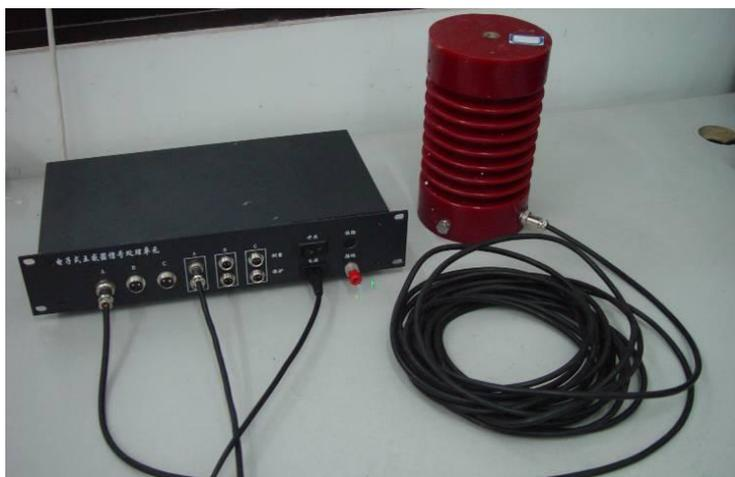
上图为：10kV 电子式电压互感器
