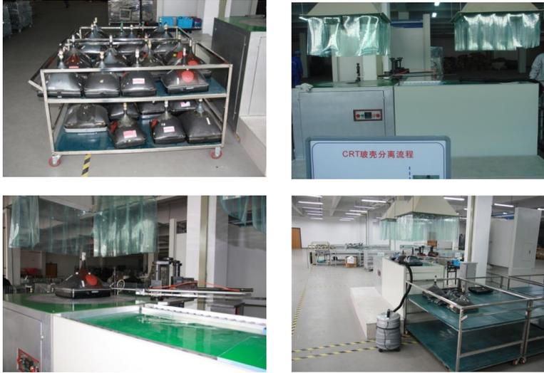
自主研发了自动缠绕电加热 CRT 锥屏分离方法及设备，可实现高效无损分离，分离效率为 2 分钟/台
