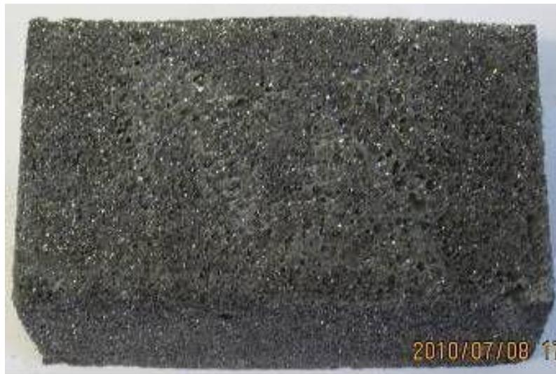
废 CRT 屏玻璃资源化产品—节能环保材料-低密度泡沫玻璃产品
