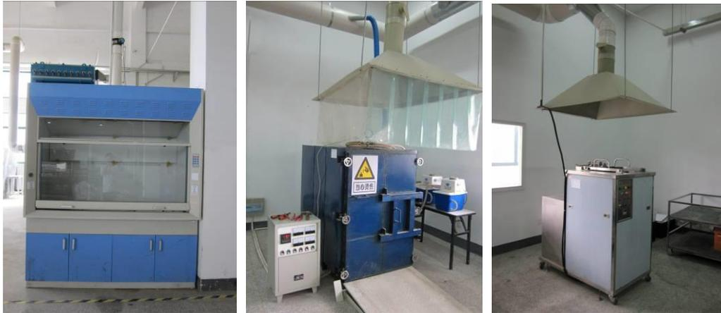
自行设计研发的 LCD 拆解负压通风橱、真空炉和玻璃清洗机
