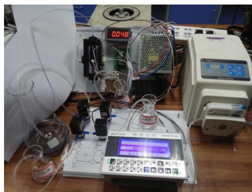
图 1 环流分析水质监测平台模型图
