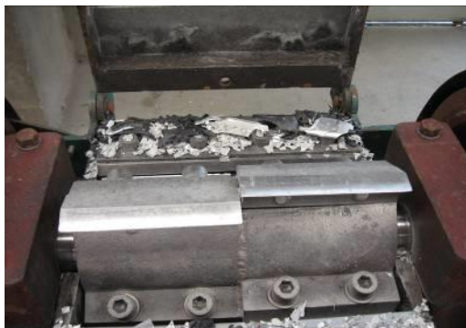
上图 线路板破碎设备专用刀具
