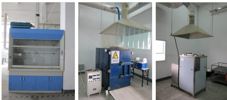
上图 自行设计研发的 LCD 拆解负压通风橱、真空炉和玻璃清洗机 (6) 废锂电池处理试验装置
