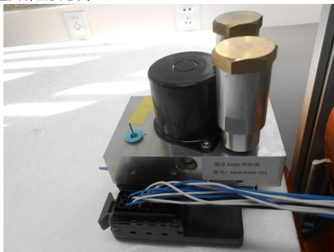
图 1 能量回馈式防抱死制动系统控制单元
