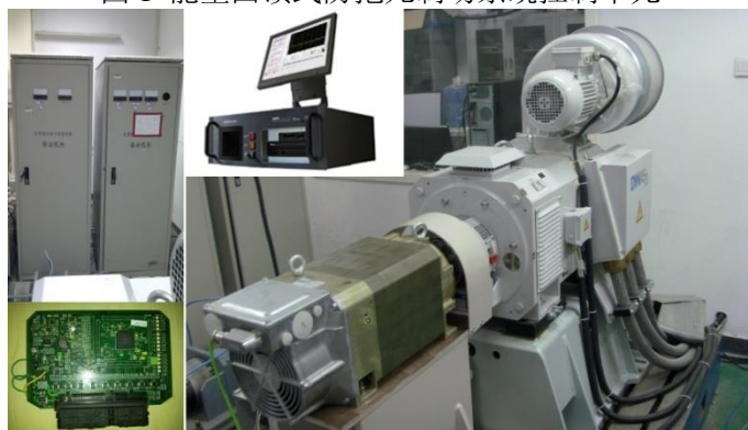
图 2 回馈制动系统动态负载模拟实验装备
