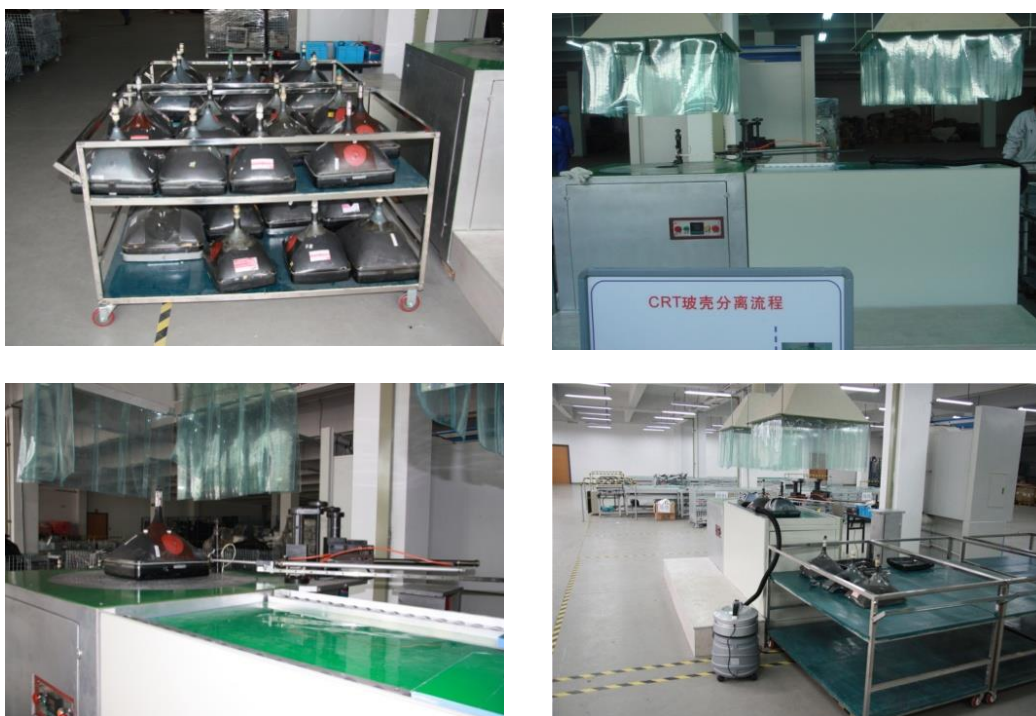
上图 自主研发了自动缠绕电加热 CRT 锥屏分离方法及设备 (可实现高效无损分离, 分离效率为 2 分钟/台)
