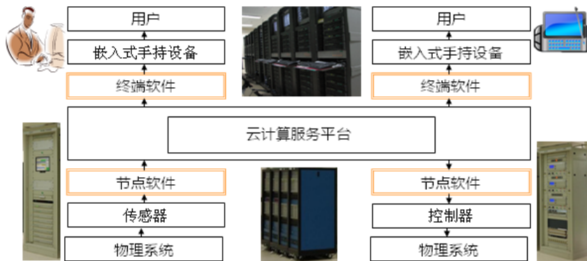
图 3 智能电网监控物联网系统架构图
