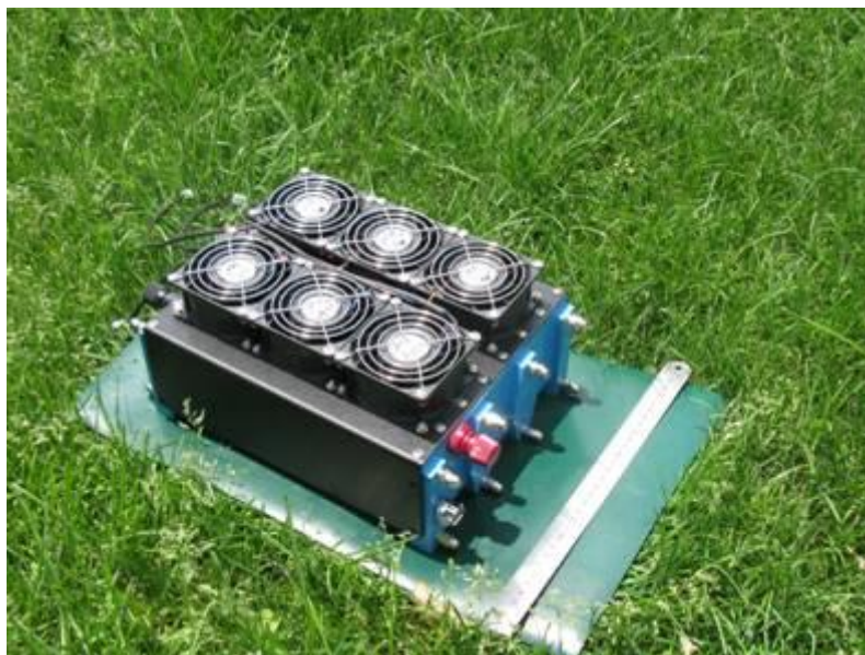
上图：1.3 千瓦 空冷、自增湿式燃料电池发电机 (43 cells)
