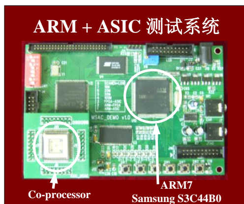
图 2 ARM+语音识别协处理的测试系统
