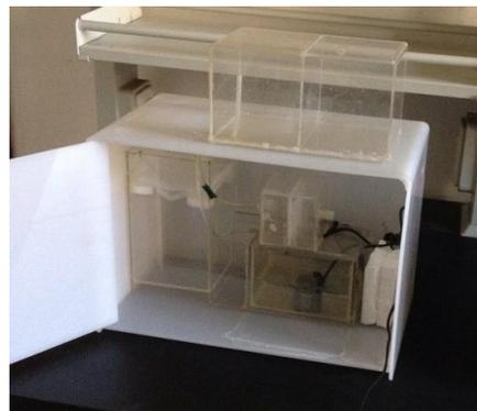
图2 第三代超声雾化空气净化器原理样机。
