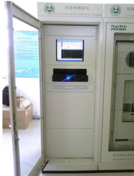
图 1 示范运行中的有机污染荧光溯源预警仪
