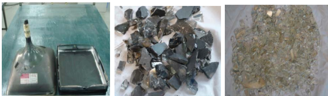
锥屏分离后的 CRT 锥玻璃和屏玻璃 清洗前锥玻璃 清洗后锥玻璃
