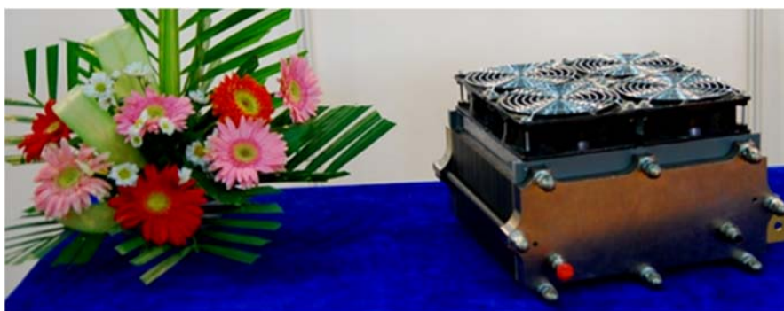
上图 车用燃料电池电堆模块（摄于第二届国际氢能与燃料电池展会）
