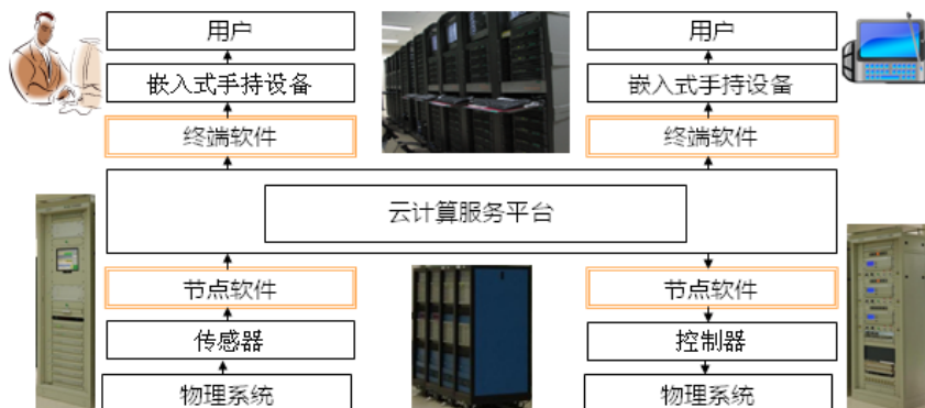
图3 智能电网监控物联网系统架构图
