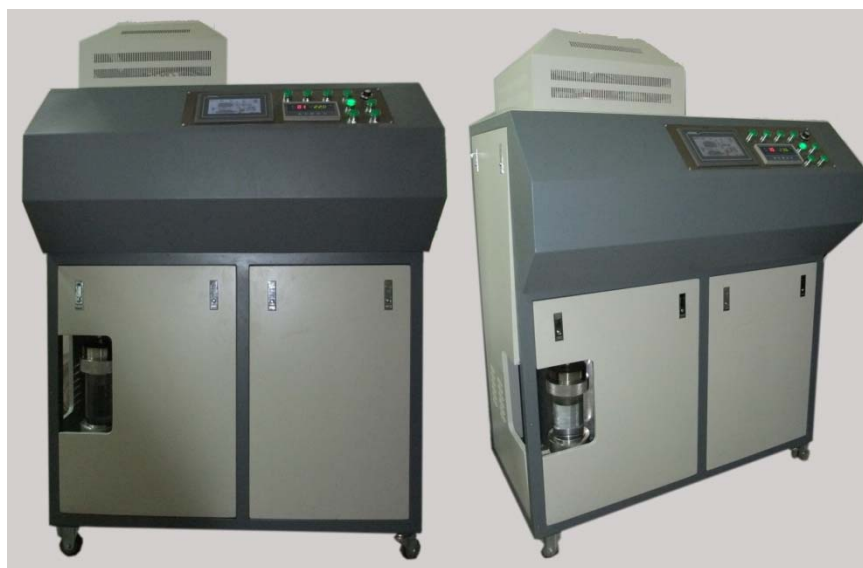
图 1 多翅片降膜蒸发紧凑式海水淡化系统样机
