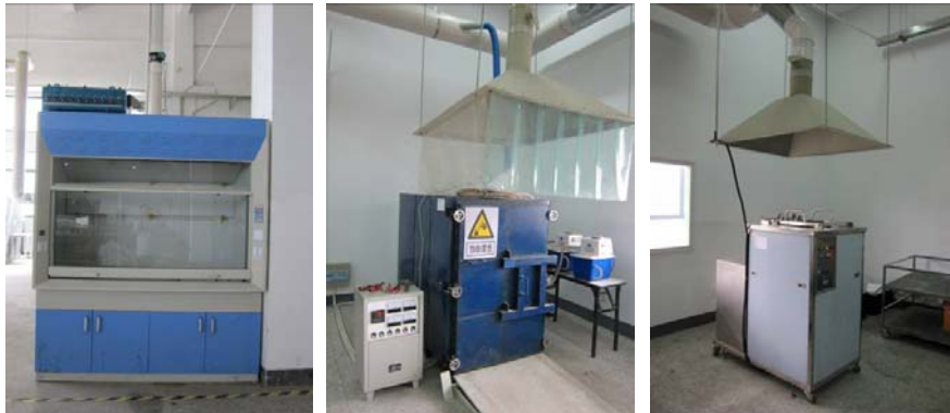
上图 自行设计研发的 LCD 拆解负压通风橱、真空炉和玻璃清洗机
