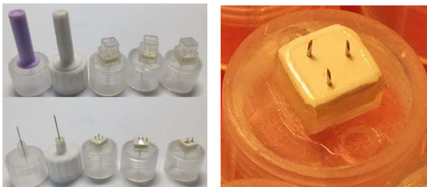
上图 研发的胰岛素注射笔用微型阵列式注射针头与市场上畅销的国外产品对比
