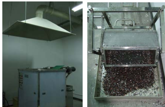
上图 锂电池超声搅拌清洗设备
