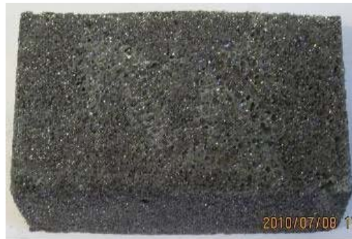
上图 废 CRT 屏玻璃资源化产品—节能环保材料-低密度泡沫玻璃产品
